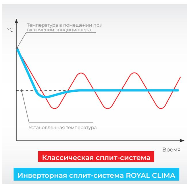
Благодаря использованию инверторных технологий ROYAL CLIMA, основанных на максимально эффективном плавном регулировании мощности компрессора, заданная температура в помещении поддерживается максимально точно.
