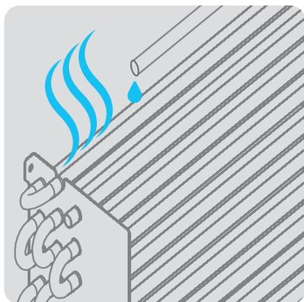
Автоматическое испарение конденсата. Резервуар с водой не заполняется полностью. Слив воды необходим только в конце сезона
