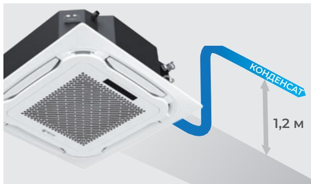
Все кассетные блоки серии ESPERTO укомплектованы встроенным дренажным насосом для отвода конденсата. Отвод конденсата от внутренних блоков происходит с помощью данной встроенной помпы (высота подъема конденсата до 750 мм) — это максимально облегчает монтаж и делает выбор места установки кондиционера намного более гибким и удобным для последующей эксплуатации.
