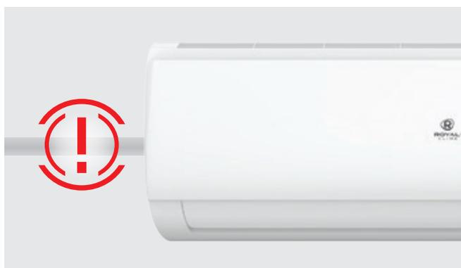
Ошибка ЕС сигнализирует об утечке хладагента. В случае ее появления необходимо выключить кондиционер и обратиться в сервисную службу для устранения неисправности. Утечка хладагента может привести к поломке кондиционера: компрессор при работе охлаждается хладагентом, и при его недостатке возможен перегрев и заклинивание компрессора.
