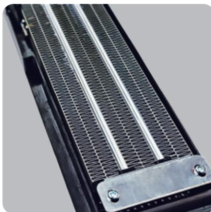
Благодаря встраиваемому нагревателю вы можете поддерживать необходимую температуру воздуха в помещении от 0 до +30 °C в зимний период времени. Даже при экстремально низкой температуре на улице -40 °C температура воздуха в помещении будет всегда в комфортном диапазоне. Нагреватель выполнен из поликристаллической керамики на основе титана и имеет срок службы более 30 000 часов
