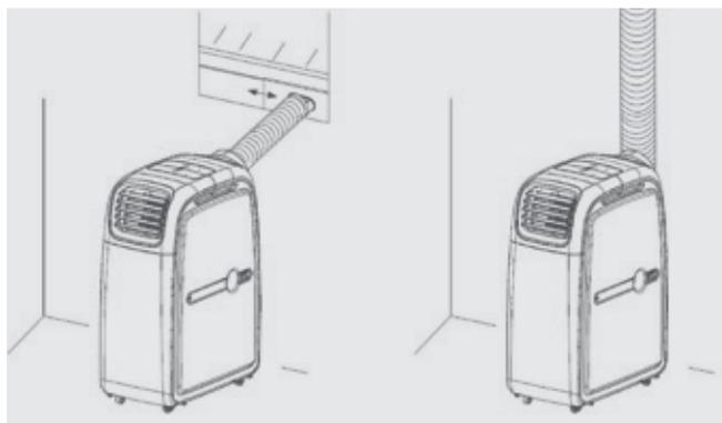
Благодаря уникальной, точно просчитанной конструкции есть возможность отвода воздуха как вертикально вверх, так и горизонтально, без потери места на изгиб воздуховода и без потери давления.
