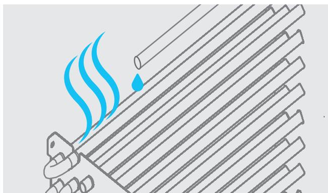
Мобильные кондиционеры серий TESORO, CELEBRITY, NEON, STRADA и LARGO PRO оборудованы системой автоматического испарения конденсата. В режиме охлаждения весь конденсат из дренажного поддона подается на теплообменник, тем самым решая две задачи: увеличение производительности и испарение конденсата. После испарения конденсат выводится через гофрошланг на улицу вместе с горячим воздухом.
