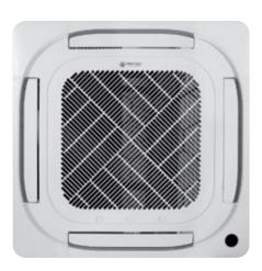
Кассетные полупромышленные блоки имеют функцию кругового (на 360°) распределения воздушного потока — для этого по углам декоративной панели и в самом блоке сделаны дополнительные отверстия, через которые воздух распределяется в дополнение к отверстиям, закрытым жалюзи. Данная функция позволяет более равномерно распределять охлажденный воздух по помещению, повышая комфорт пользователей.
