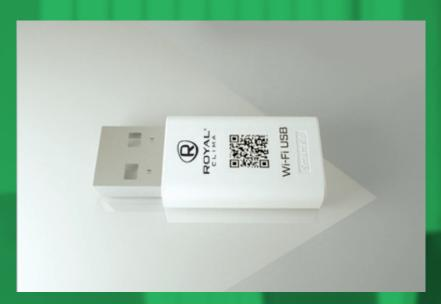
Возможность управления функциями кондиционера через Wi-Fi с мобильного устройства (опция для внутренних блоков настенного типа)
