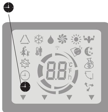
Кнопками ▲ и ▼ установите время до отключения кондиционера. Для отмены выключения кондиционера по таймеру нажмите кнопку TIMER еще раз.
