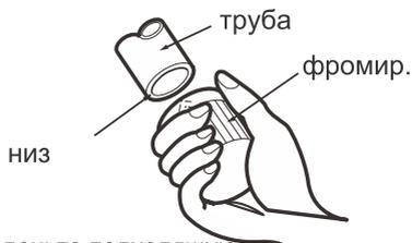
C: наденьте подходящую изоляционную трубу.
